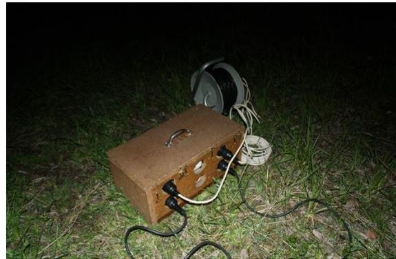
Stromgenerator und Elektroanschlüsse mit Drossel für spezielle HQL-Quecksilberdampf Lampen
